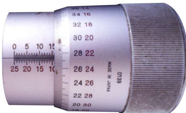
4. ábra: Példa a Mitutoyo mikroszkóp mérőorsójának leolvasásához
