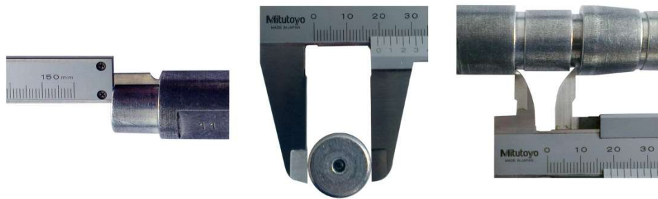
9. ábra: Mélység, külső és belső méretek mérése tolómérővel
