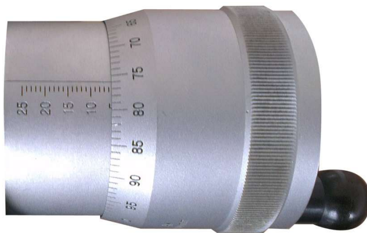
3. ábra: Példa a Zeiss mikroszkóp mérőorsójának leolvasásához
